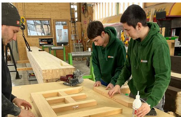
Fertigung der Führungsschienen
